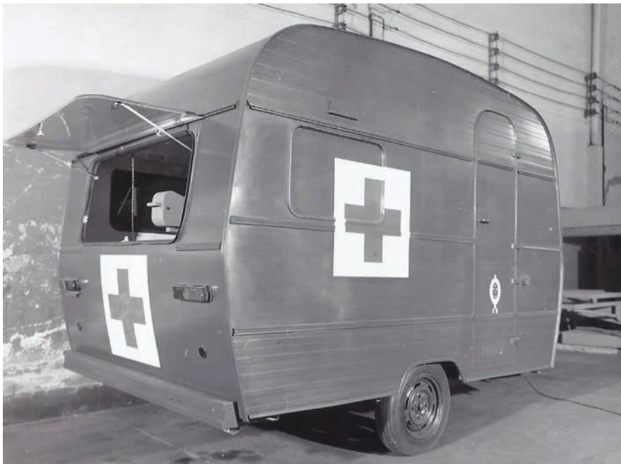
103. Aparelho para abreugrafias, montado em trailer, para o Exército Brasileiro.
