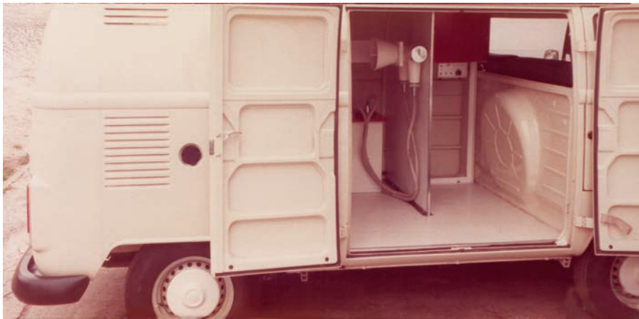
110. Aparelho de raios-X para abreugrafias, instalado em uma Kombi-VW.
