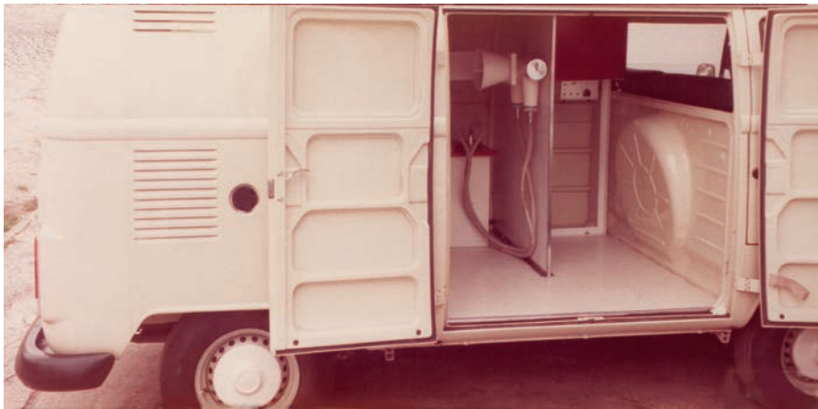
110. Abreugrafiegerät in einer VW-Kombi montiert.
